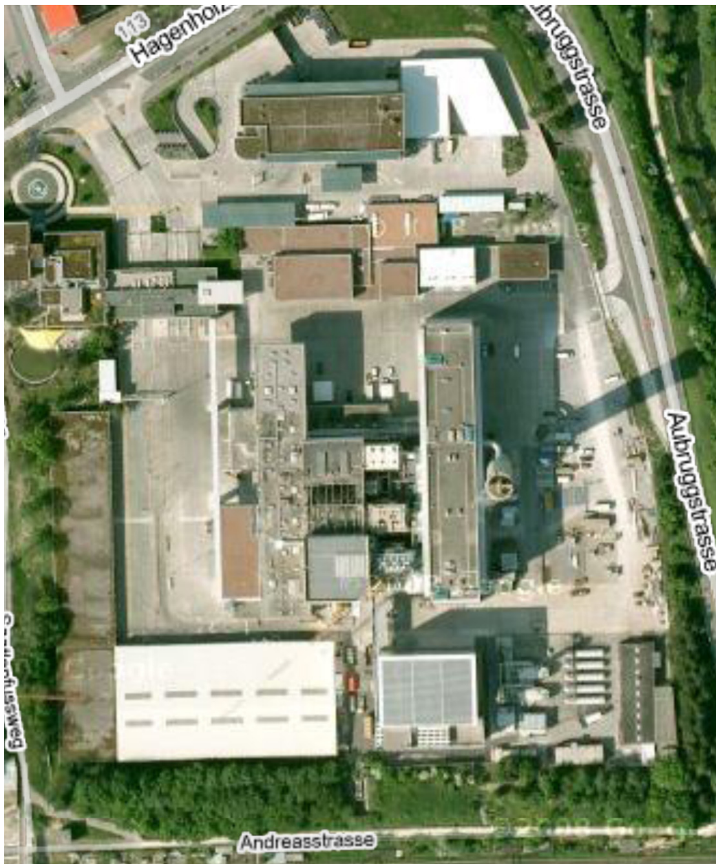
Abb. 3: Luftbild der Anlagen Hagenholz der ERZ (Kehrichtheizkraftwerk mit Waagen, Recyclinghof, Sonderabfallsammelstelle etc.). Gut sichtbar sind das neue Energiegebäude (unten) und beim Ofenhaus (Mitte) der Umbau der Linie 1 (Zustand ungefähr 2008).
